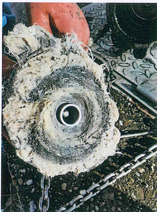
2. fotó: Átemelő szivattyú járókereire feltekeredő szálanyag illusztrálva
