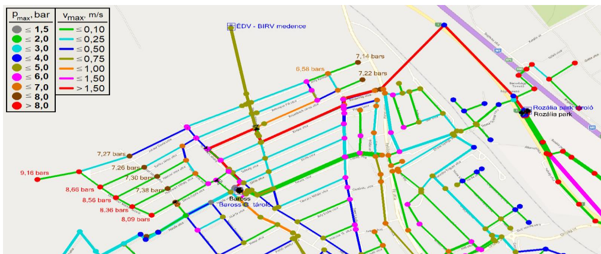
4-7. ábra. Az új zónán fellépő nyomásértékek az ÉDV felőli átvételi lehetőségek függvényében
