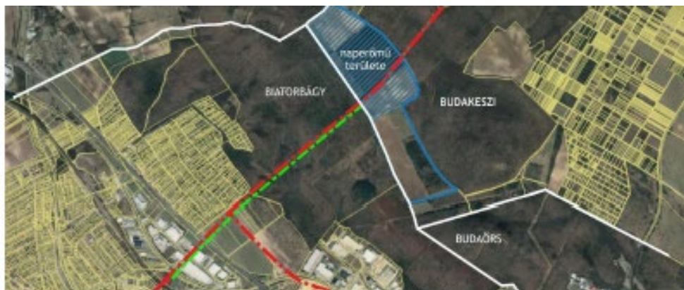
A meglévő (piros) és az új (zöld) 132 kV-os hálózati vezeték nyomvonala (Forrás: KKS Energy Kft., saját készítés)
